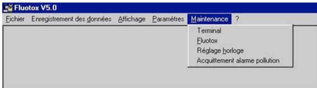
Ce menu permet de visualiser l'état du Fluotox, de régler son horloge et d'acquitter les pollutions. Contrairement au bouton poussoir présent sur la face avant du Fluotox, l'acquittement ne permet pas de réaliser un nouveau prélèvement.
