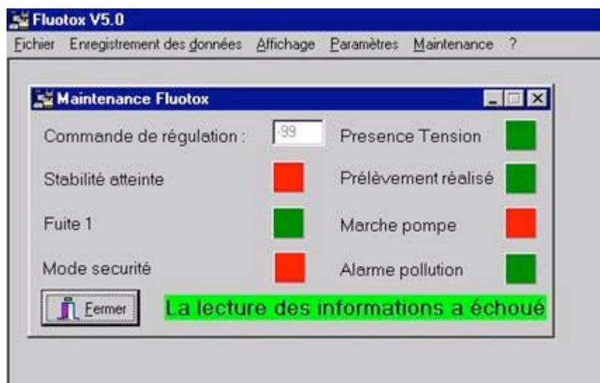
**Commande régulation** : indique la quantité en % de la puissance utilisée pour le chauffage de l'eau. Le signe indique si le système chauffe ou refroidi. (+ ↔ chauffage ; - ↔ refroidissement),
