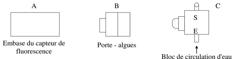
Le bloc porte - algue B peut alors être remis en place entre l'embase A et le bloc de circulation d'eau C.
